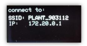
Wenn das WLAN gefunden wurde, drücken Sie auf "Verbinden" und akzeptieren Sie Meldungen die darauf hinweisen, dass kein Internet mit diesem WLAN verfügbar ist (diese Meldung kommt nur in seltenen Fällen). Danach ist man mit dem Modul direkt verbunden. Nun muss im nächsten Schritt die Verbindung mit dem Internet hergestellt werden.
