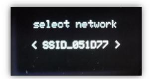
Über den Drehklick-Knopf kann man im nächsten Schritt das Passwort eingeben. Durch langes Drücken des Knopfes kommt man zu den Unterpunkten "Back" und "Done". Stellen Sie sicher, dass eine Verbindung zum Heimnetzwerk möglich ist und ein gutes Signal am FG Modul ankommt.
